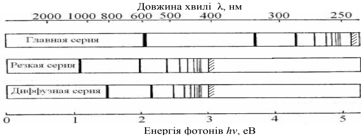
Рис. 2. Спектральні серії атома Na, межі серій показані штриховкою
