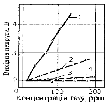
Рис. 16.27. Залежність вихідної напруги сенсора від концентрації CO (криві 1, 4) і H 2 (криві 2, 3) для нелегованих (криві 2, 4) і легованих ThO 2 (криві 1, 3) взірців при температурі 470 К; вміст кремнезему 15,4 ваг.%, величина R p =411,5 кОм.
