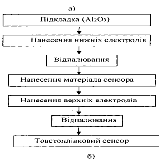
Рис. 16.25. Схеми основних процесів виготовлення товстоплівкових сенсорів планарної конструкції (а) і «сендвіч» – типу (б).
