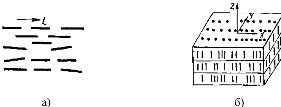
Рис.11.11 Структури рідких кристалів: а) нематичного типу, б) смектичного типу
